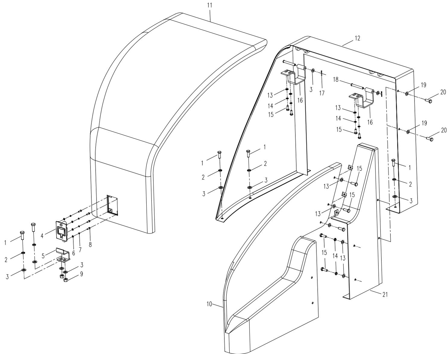
10.1.1 发动机罩（使用858,858A机型）ENGINE HOOD (APPLY TO 858,858A TYPE)
