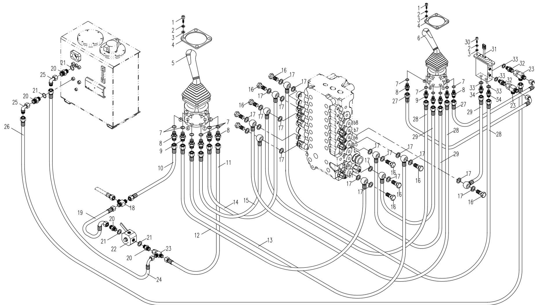
85.3.1 先导部分的液压系统3 ( 适用858、858A机型 ) HYDRAULIC SYSTEM FOR PILOT PART 3 APPLY TO 858,858A TYPE )
