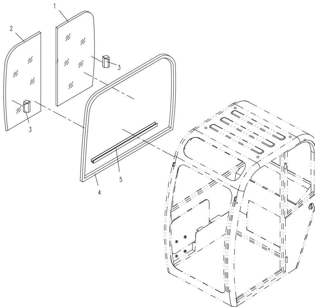
07.4.1 驾驶室组件4(适用858机型,内销机型) CAB SUBASSEMBLY 4(APPLY TO 858 TYPE)
