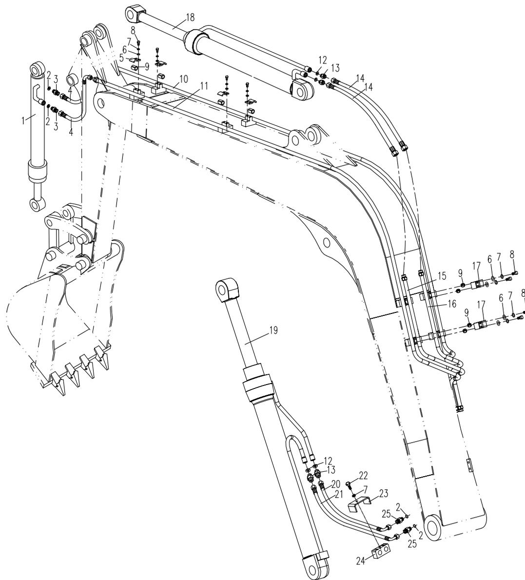
95.2.1 工作装置部分的液压系统2(适用858、858A机型) HYDRAULIC SYSTEM FOR WORKING EQUIPMENT 2 ( APPLY TO 856,856A TYPI
