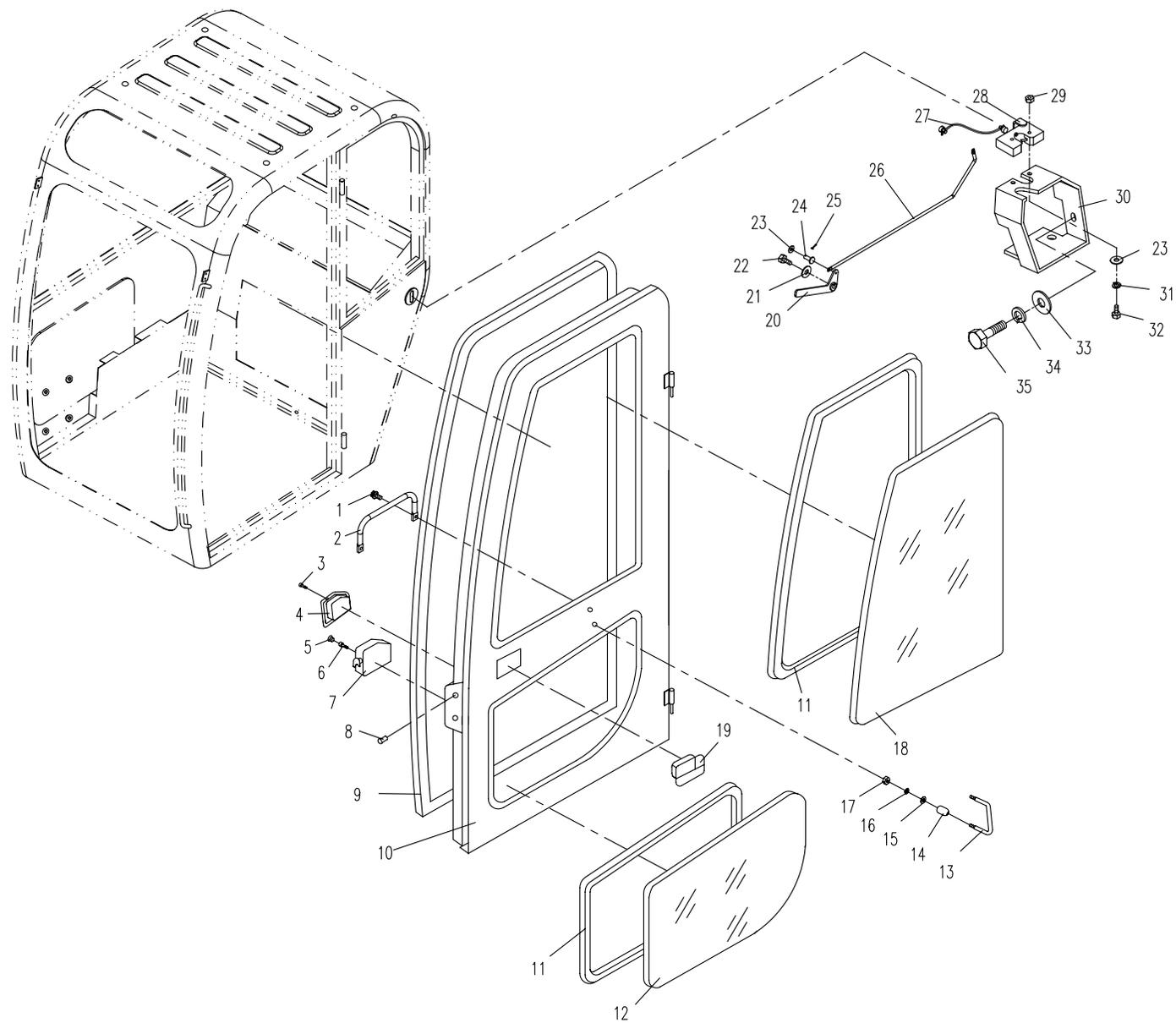
07.3.1 驾驶室组件1(适用858机型, 内销机型) CAB SUBASSEMBLY 1(APPLY TO 858 TYPE)
