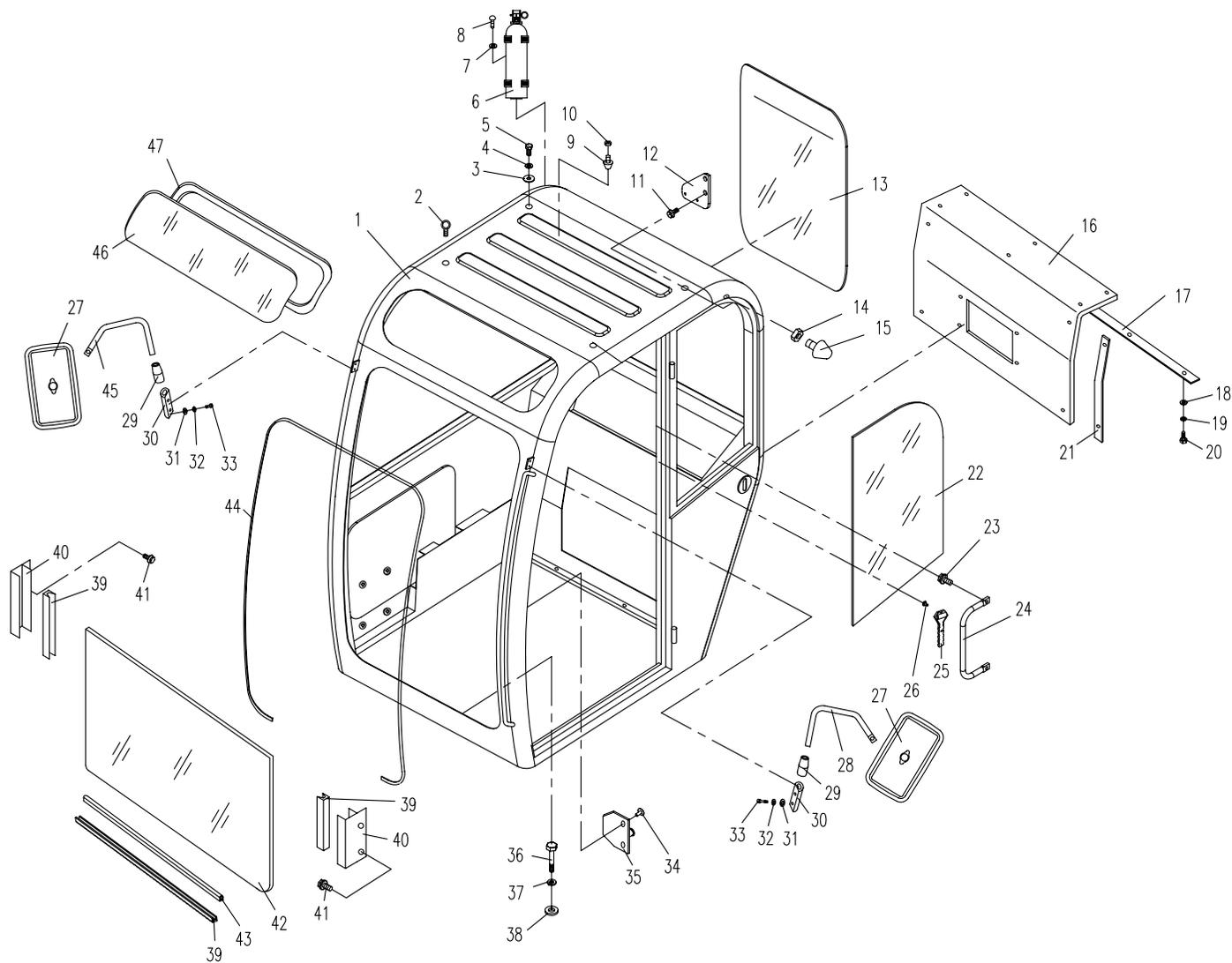
07.1.1 驾驶室组件1(适用858机型,内销机型) CAB SUBASSEMBLY 1(APPLY TO 858 TYPE)
