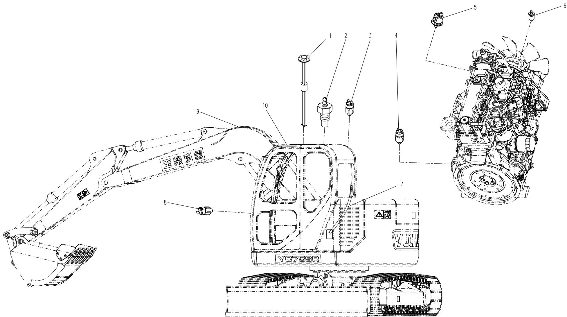
13.4.1 电气系统 电气总装IV(适用858机型) ELECTRICAL SYSTEM ELECTRICAL ASSEMBLY IV (APPLY TO 858 TYPE)
