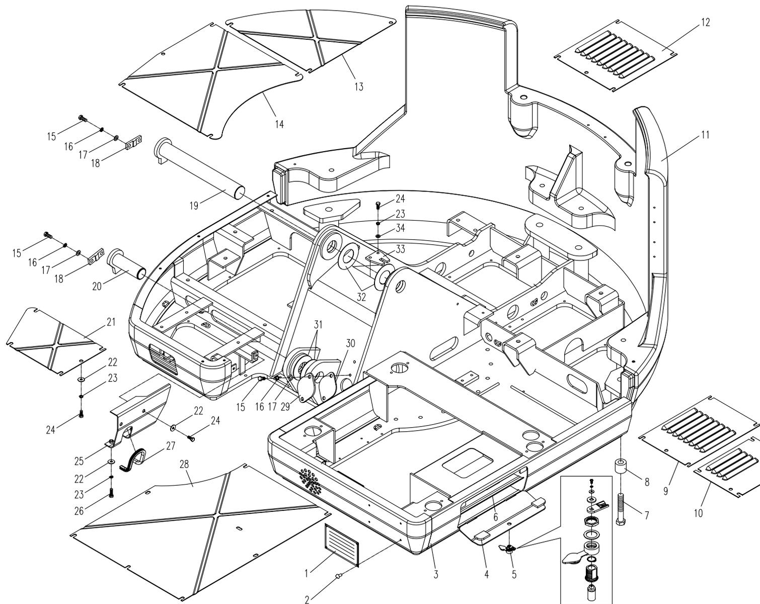
02.1.1 回转平台(适用858机型) SLEWING PLATFORM(APPLY TO 858 TYPE)
