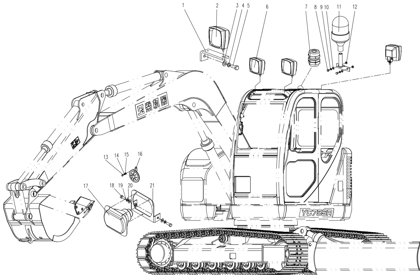
13.2.1 电气系统 电气总装II(适用858机型) ELECTRICAL SYSTEM ELECTRICAL ASSEMBLY II(APPLY TO 858 TYPE)
