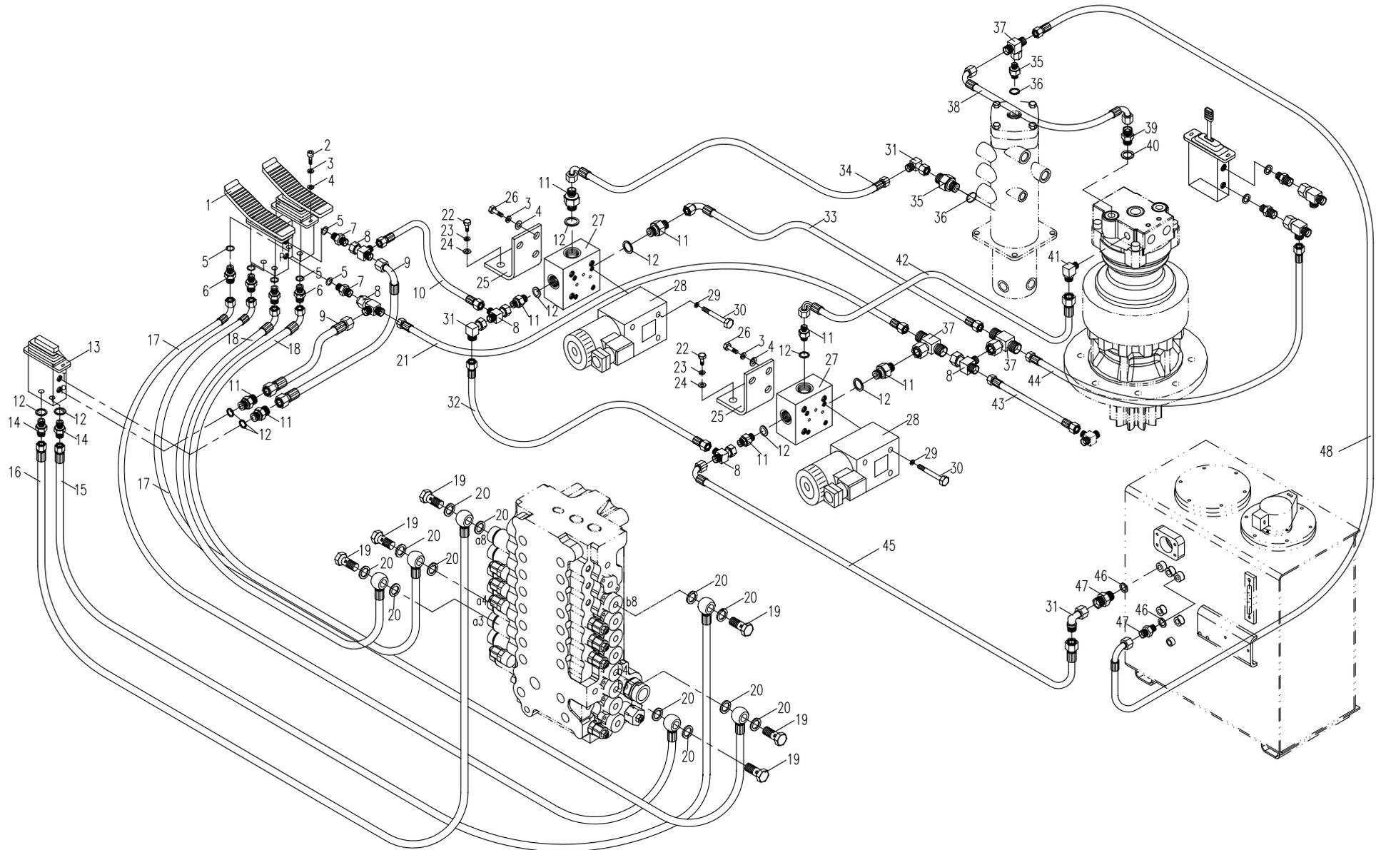
95.1.1 工作装置部分的液压系统1 (适用858、858A机型) HYDRAULIC SYSTEM FOR WORKING EQUIPMENT 1 (APPLY TO 858,858A TYPE )
