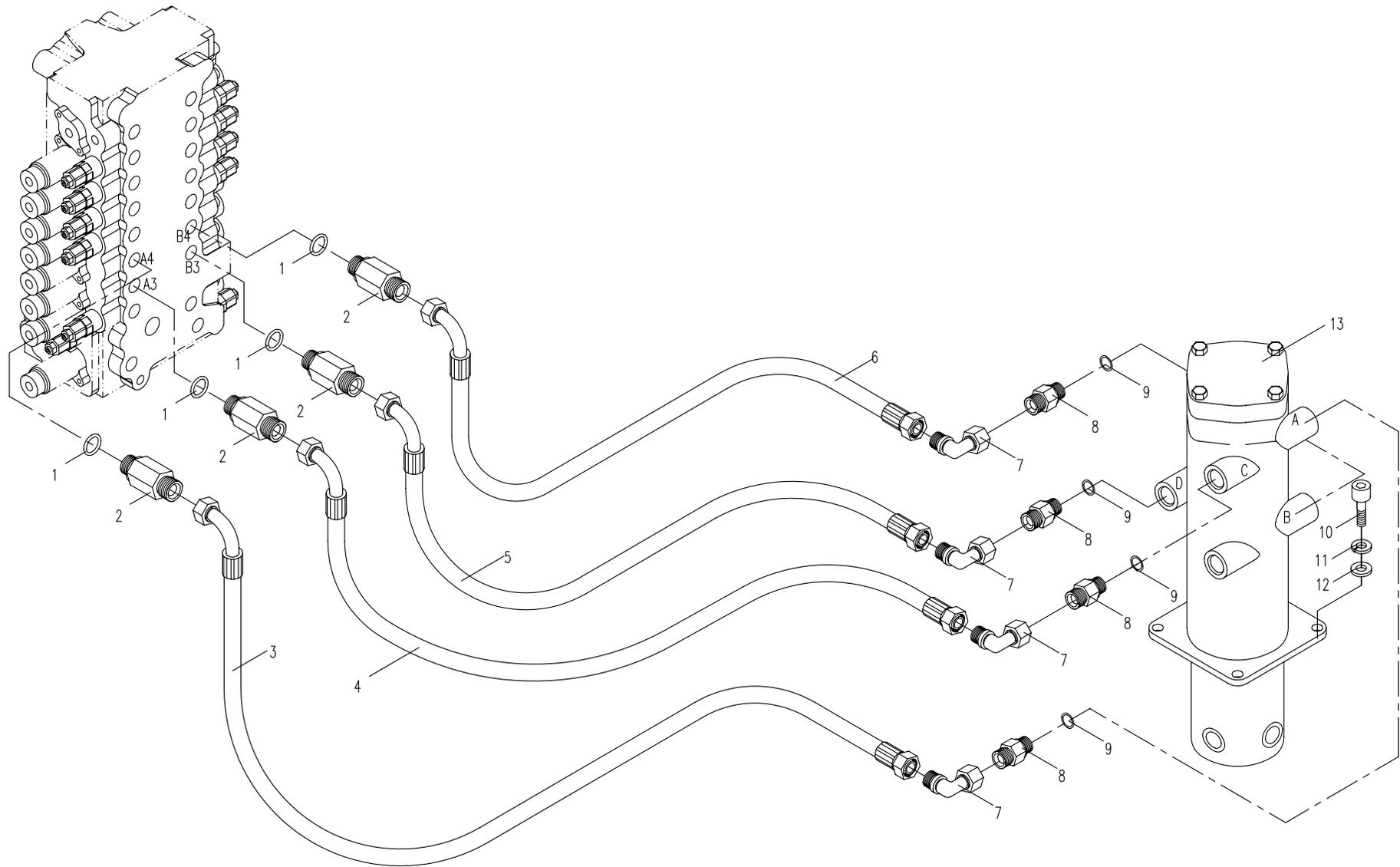
05.7.1 平台部分的液压系统7 (适用858机型) HYDRAULIC SYSTEM FOR PLATFORM 7 (APPLY TO 858 TYPE )
