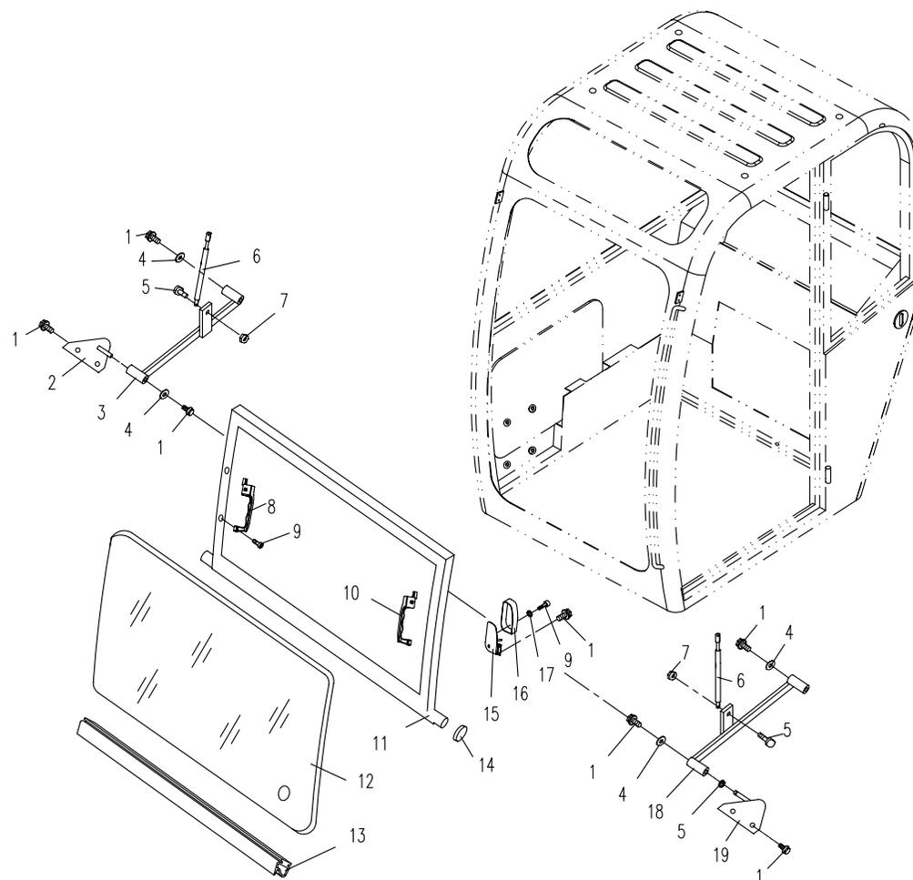
07.5.1 驾驶室组件1(适用858机型,内销机型) CAB SUBASSEMBLY 1(APPLY TO 858 TYPE)
