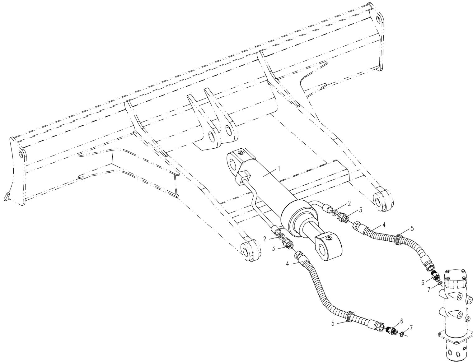
85.1.1 先导部分的液压系统1 ( 适用858,858A机型 ) HYDRAULIC SYSTEM FOR PILOT PART 1 ( APPLY TO 858,858A TYPE )
