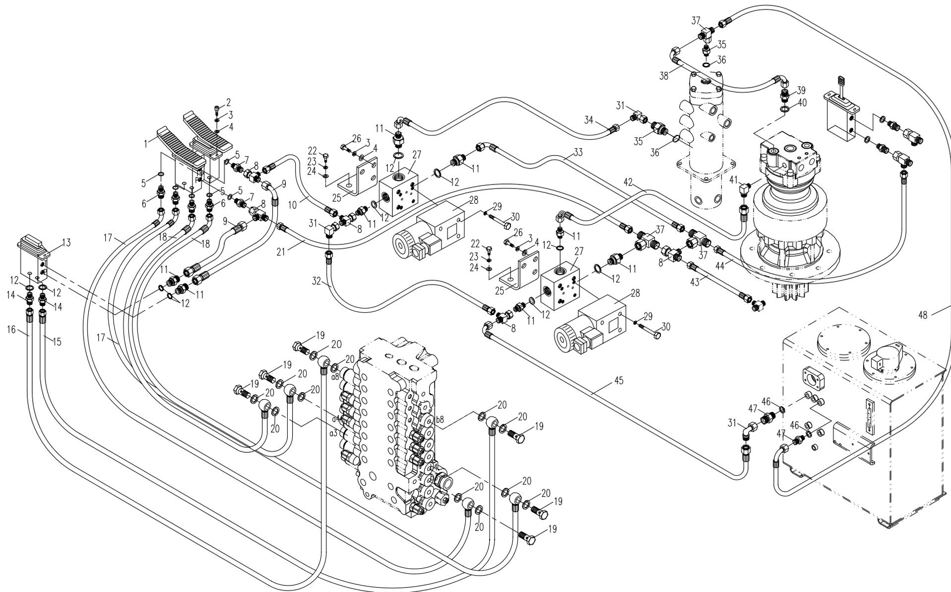
85.3.1 先导部分的液压系统3 ( 适用858、858A机型 ) HYDRAULIC SYSTEM FOR PILOT PART 3 APPLY TO 858,858A TYPE )
