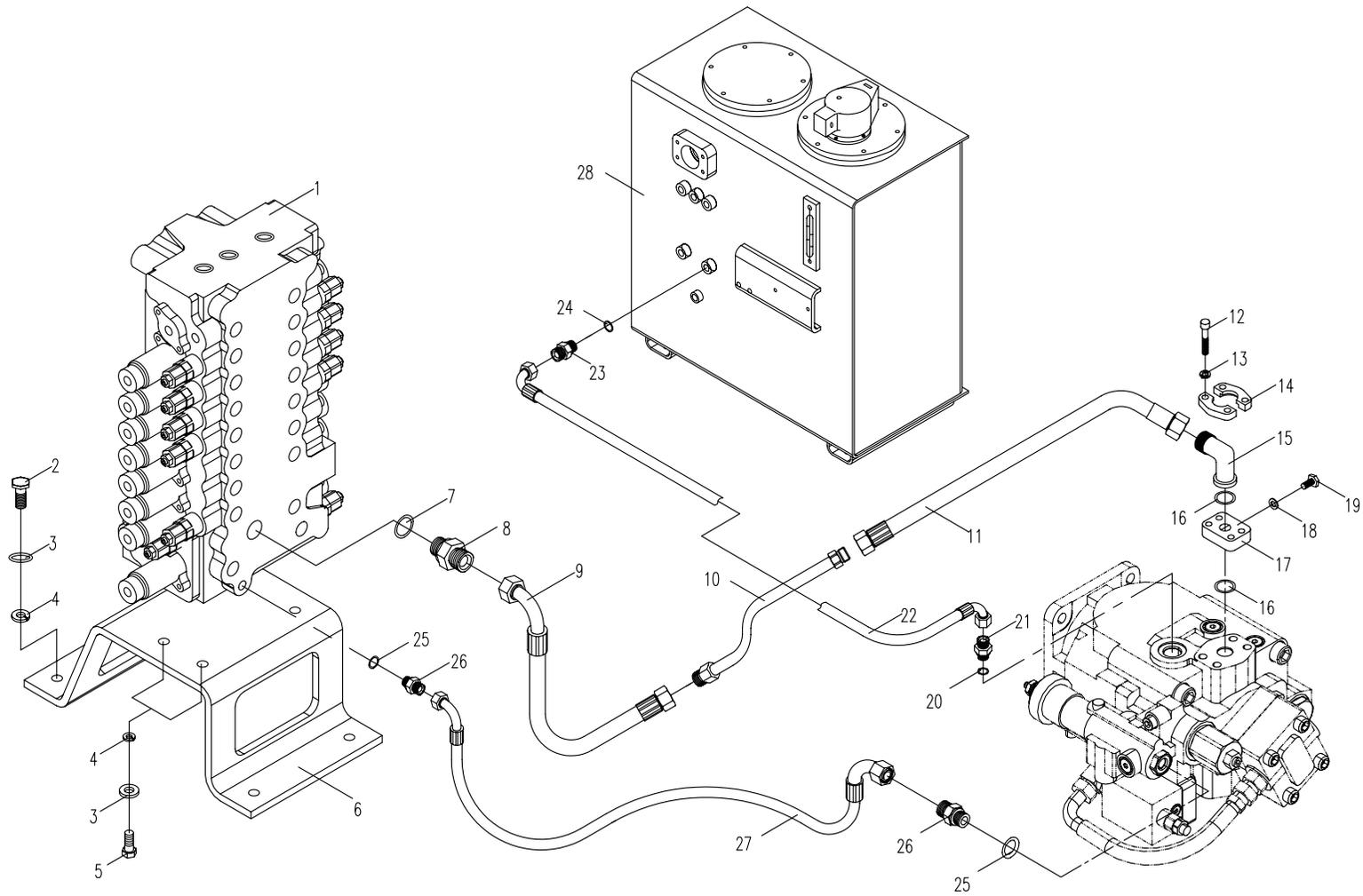
05.4.1 平台部分的液压系统4 (适用858,858A机型) HYDRAULIC SYSTEM FOR PLATFORM 4 (APPLY TO 858,858A TYPE)
