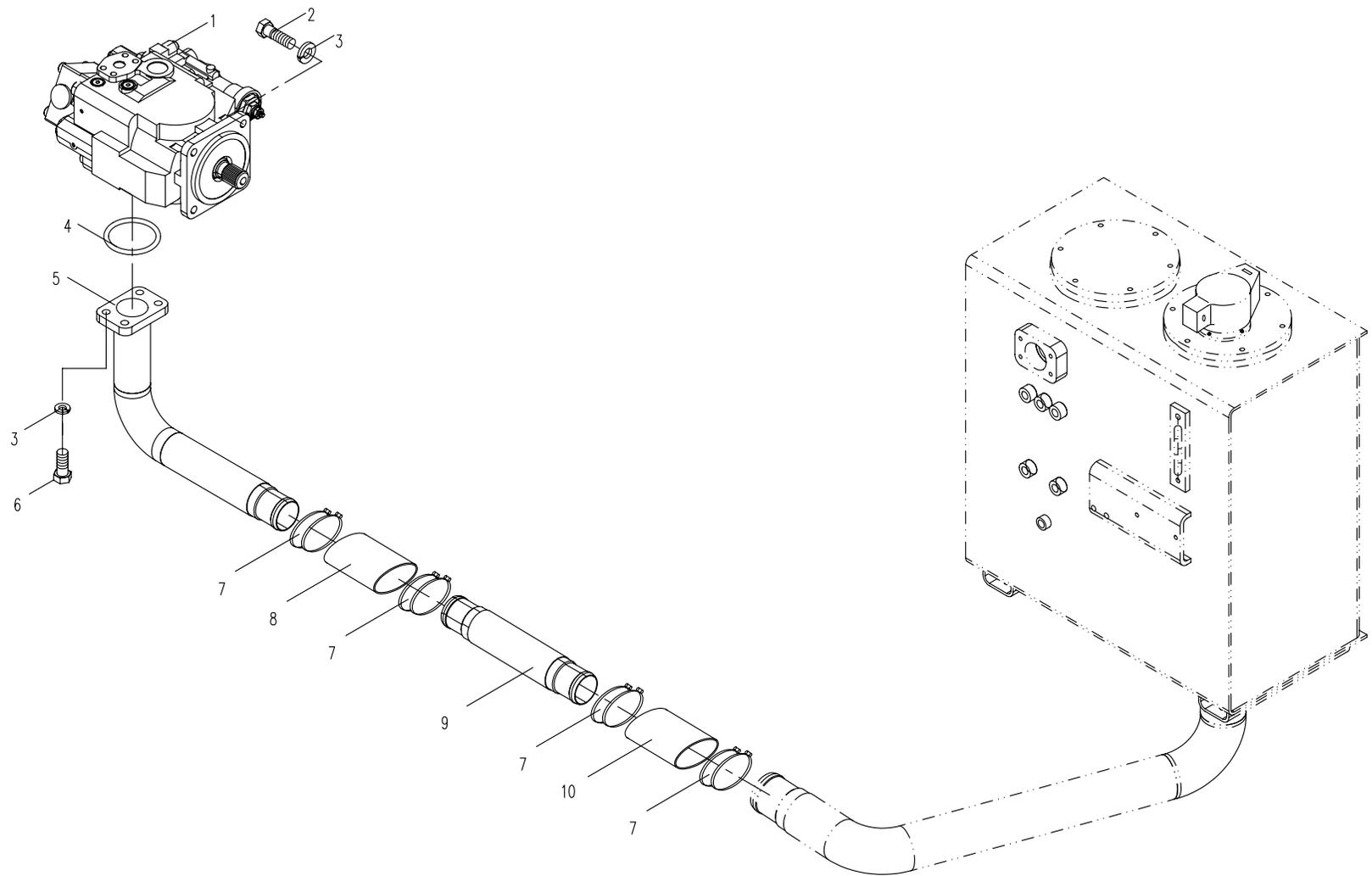
05.3.1 平台部分的液压系统3 (适用858机型) HYDRAULIC SYSTEM FOR PLATFORM 3 (APPLY TO 858 TYPE )
