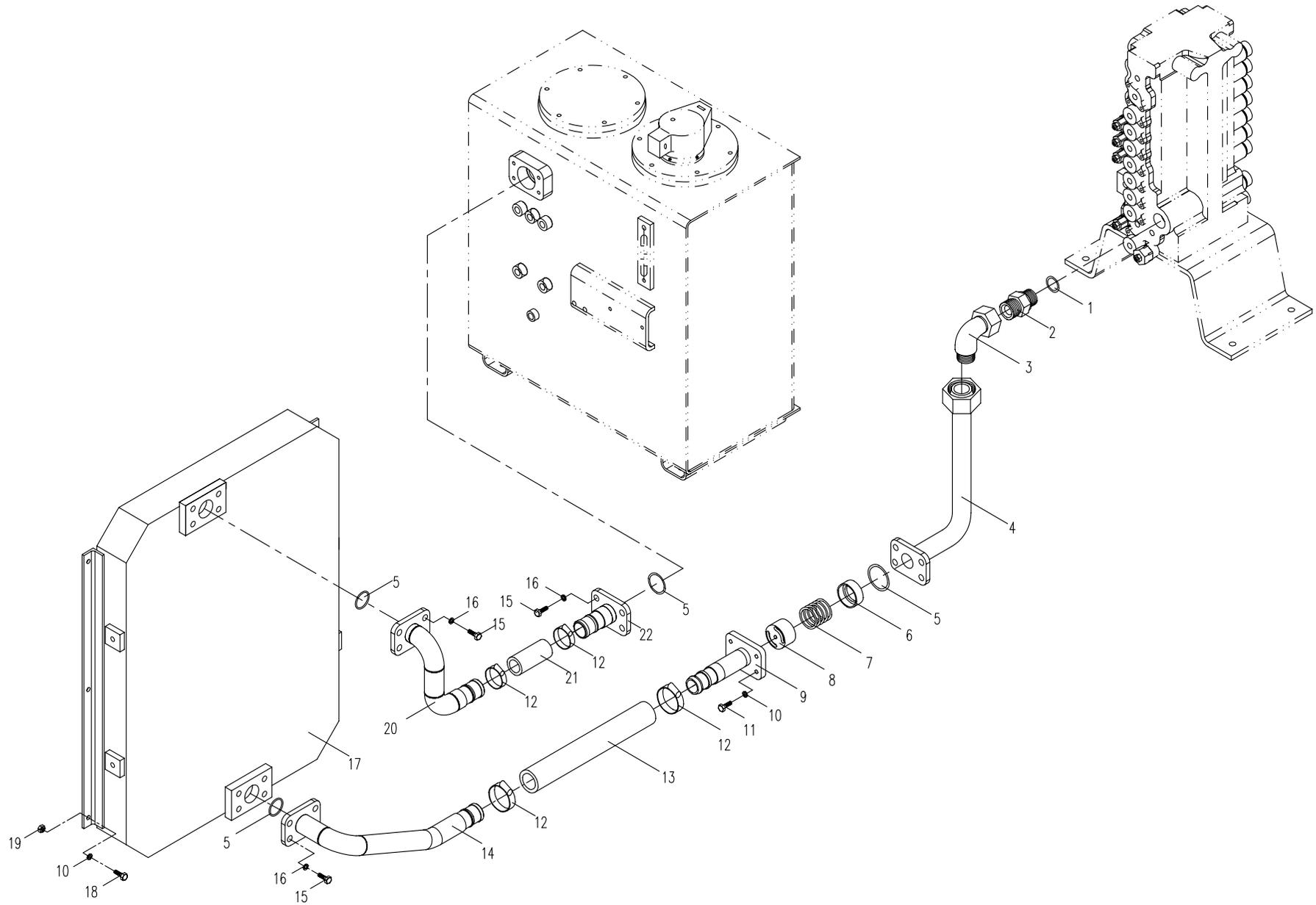
05.6.1 平台部分的液压系统6 (适用858,858A机型) HYDRAULIC SYSTEM FOR PLATFORM 6 (APPLY TO 858,858A TYPE)
