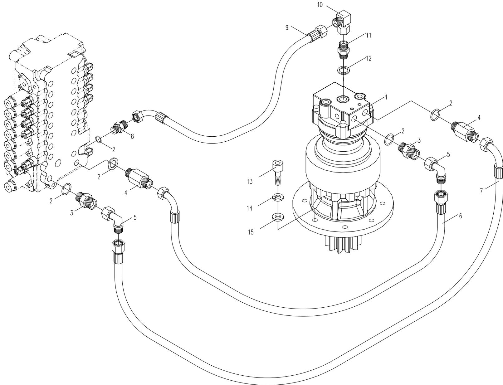
05.5.1 平台部分的液压系统5 (适用858机型) HYDRAULIC SYSTEM FOR PLATFORM 5 ( APPLY TO 858 TYPE )
