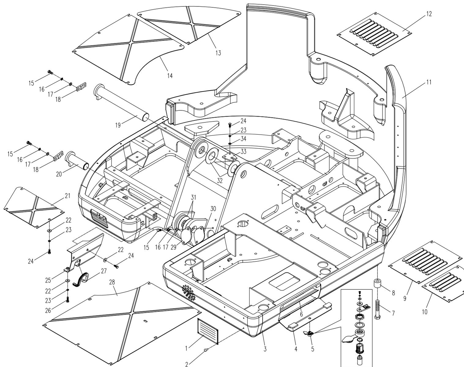
03.1.1 推土装置 (适用858、858A机型) DOZER EQUIPMENT (APPLY TO 858,858A TYPE)
